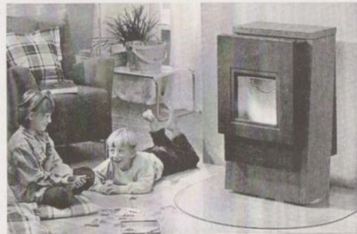
Abb. 1: Attraktiver Blickfang im Wohnzimmer: Der Primärofenkessel Smart der Firma Wodtke gibt 20% seiner Wärme durch Strahlung an den Raum ab, 80% gelangen über einen eingebauten Luft/Wasser-Wärmetauscher zum Pufferspeicher im Keller. Foto: Wodtke
