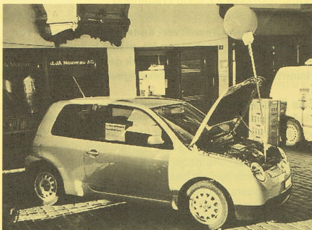
VW Lupo TDI mit Pflanzenölbetrieb Verbrauch 3 Liter Rapsöl / 100km
